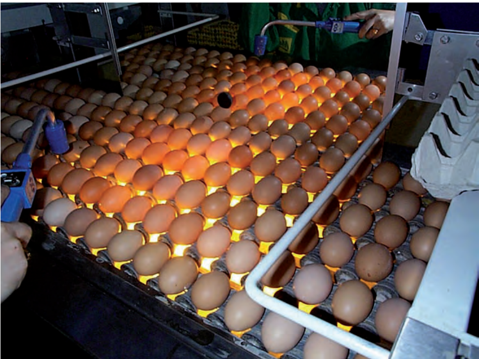
Photographie 18. Table de mirage semi-automatique (voir page 256).
