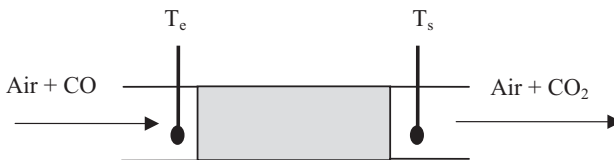
Figure 9.1. Schéma du dispositif de dosage du monoxyde de carbone.
